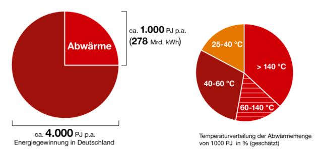
Abwärmepotenzial in Deutschland im Vergleich zur Energiegewinnung und Temperaturverteilung der Abwärmemenge [Netzwerk Nutzung Industrieller Abwärme]
